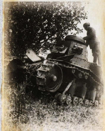
Танк МС-1 на учениях, 1932 год. Хорошо виден трехстворчатый люк для посадки механика-водителя.
